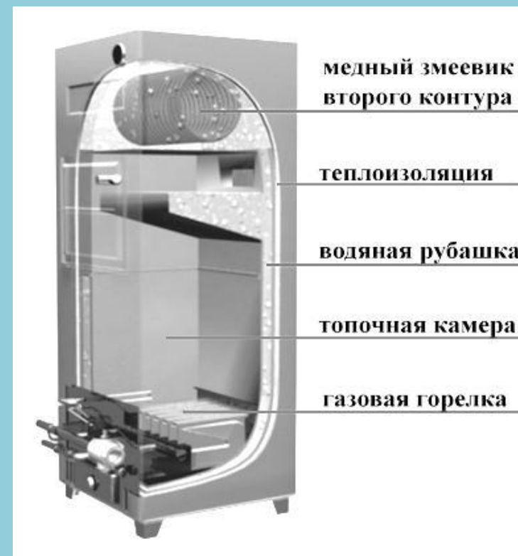
Рисунок 2.10 Характеристика котла Мимакс
